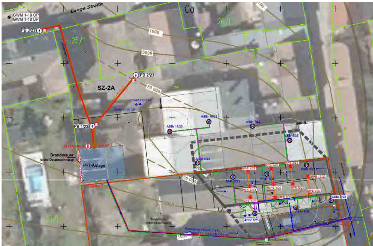
Abbildung 4: Geplante Sanierungselemente für Air-Sparging, MPE und Abstrom-Pump&Treat.
