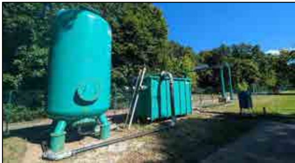
Abbildung 4: Bild links: Druckerhöhungsanlage mit Kiesfilter, Quelle: SenMVKU; Bild rechts: DSI-Lanzensystem, Quelle: SenMVKU
