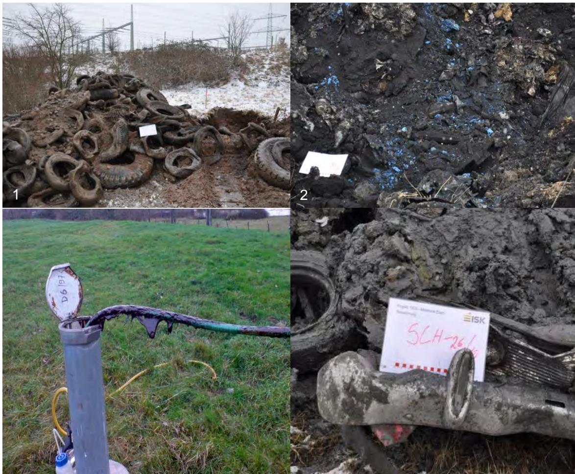
**Abb. 2: Inhalte der Altdeponie: 1 Altreifen, 2 chem. Reststoffe, 3 MKW-Phase bei Probe-nahme, 4 Autowrack; (Quelle: Dokumentation der Erkundungen)**
