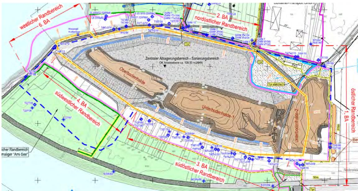
Abb. 4: Übersichtslageplan mit Bauabschnitten
