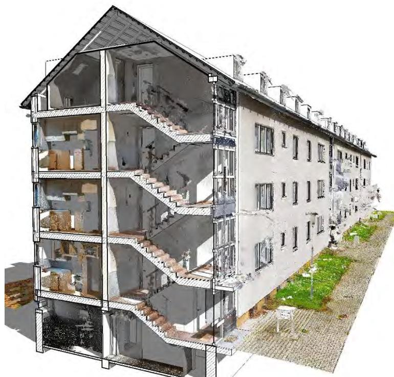
Abbildung 3: Überlagerung Punktwolke und BIM-Modell © CDM Smith
