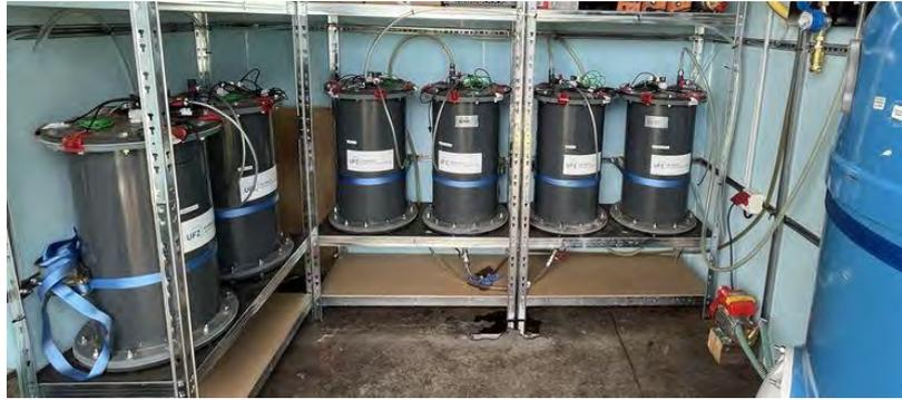
**Abb. 2: Elektrosorptionsmodule in der FABEKO-Pilotanlage.** (Foto: Robert Köhler, UFZ)
