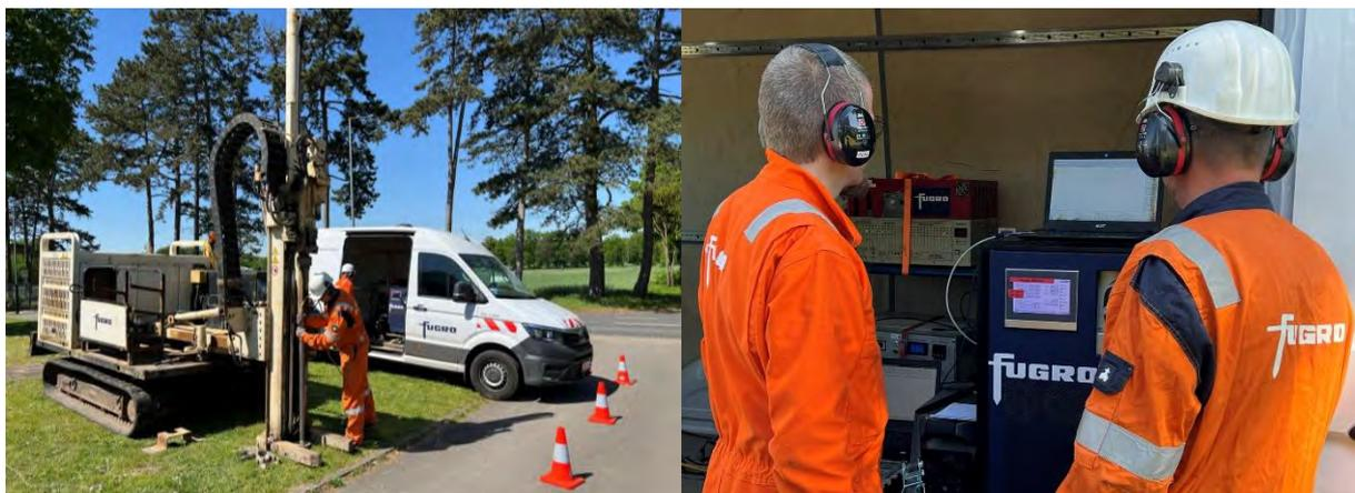
**Durchführung einer hochauflösenden Standortcharakterisierung als solide Basis zur Klärung der räumlichen und funktionalen Zusammenhänge im Quellen- und Fahnenbereich zur Erstellung zuverlässiger 3D Standortmodelle in Bezug auf Lithologie, Hydraulik und Kontamination**
