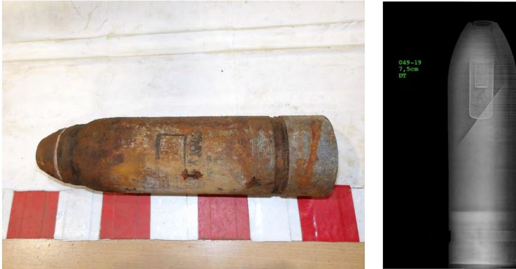
**Abb. 7: Beispiele von geborgener Munition (75 mm KS-Granate italienischer Bauart; im Röntgenbild ist die flüssige KS-Füllung zu erkennen) (Fotos: GEKA)**
