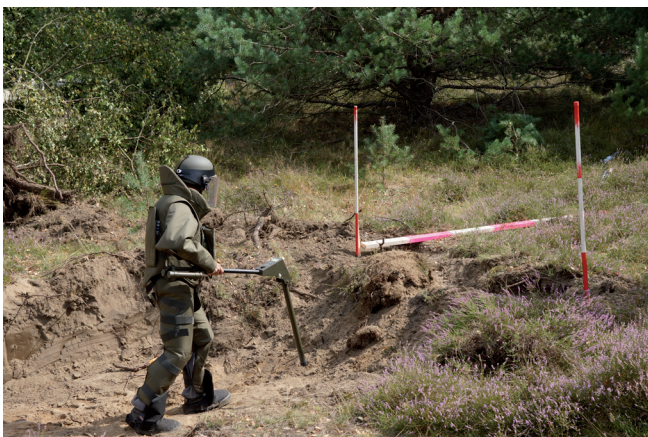
Abb. 2: Sondierung mit Fluxgate-Vertikalgradiometer auf einer Räumstelle auf dem ehemaligen Truppenübungsplatz Wittstock. Foto: Winkelmann.
