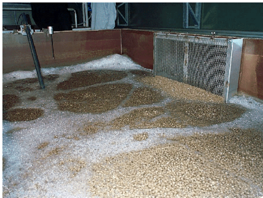
Abb. 44: belüfteter Wirbelbettreaktor (Quelle: www.sanying.com.tw )
