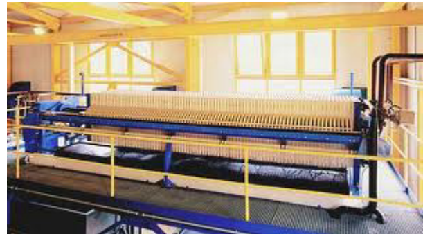
Abb. 25: Vollautomatische Kammerfilterpresse (Quelle: www.krausse-filtration.de )
